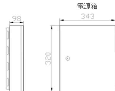
電源箱包括 LED 電源供應器、突波保護器、無熔絲開關、定時開關
